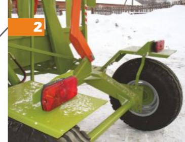
Усиленная рамная конструкция резчика.
