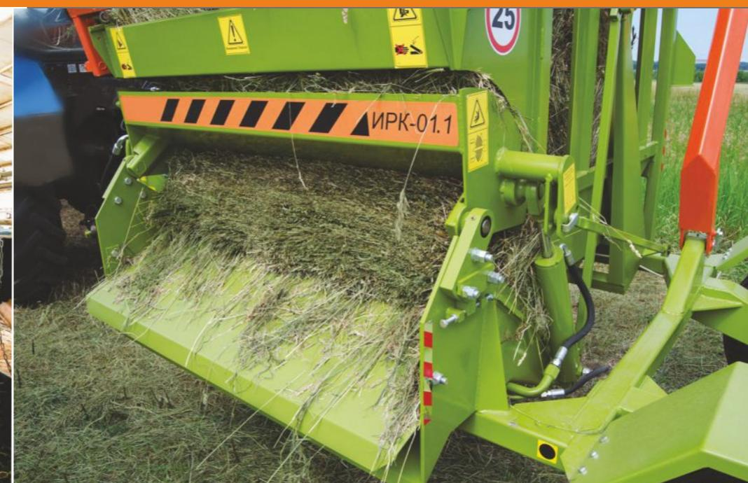
На ресурсных испытаниях резчик рулона проходит 500 км. Производительность резчика 7-10 рулона в час.
