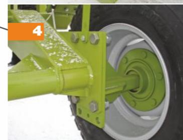
Двухколесная схема с увеличенным диаметром колес.
