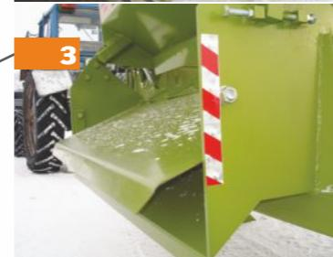
На резчики рулона устанавливается вся необходимая световая техника (габариты, стоп-сигнал, поворотник), стандартный разъем подключения.
